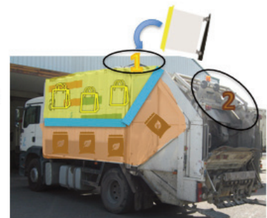
Los contenedores amarillos se cargan por la tolva 1.
