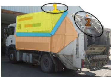
Kamioiak bi konpartimentu ditu guztiz bereizitakoak
